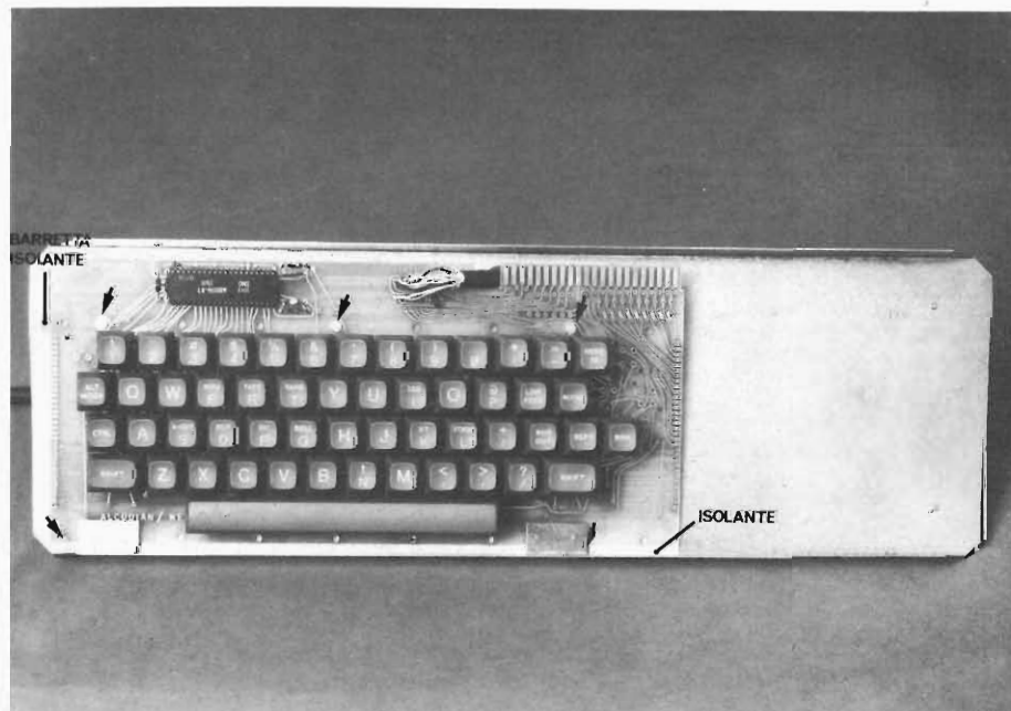
Fig. 7 - In questa fotografia si mostra la giusta allocazione del circuito stampato della tastiera sulla parte metallica della carrozzeria. Le frecce stanno ad indicare i punti dove occorre fare particolare attenzione.
